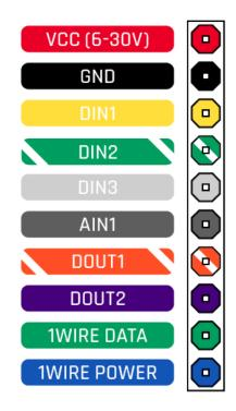
Figure 2 FMB204 wires
